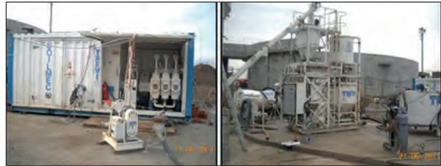
Figura 16. Equipo de inyección y planta de lechada. Fuente: Pilotes Trevi.
