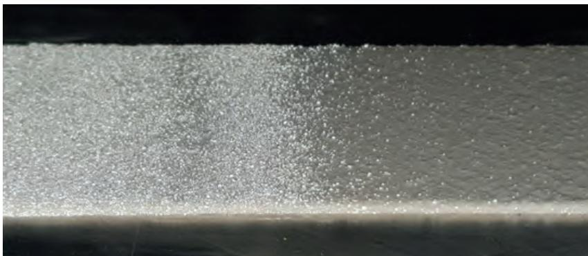
**Figura 1.** Diferencia en el aspecto visual de las muestras de demarcación con adición de microesferas. Fuente: elaboración propia.
