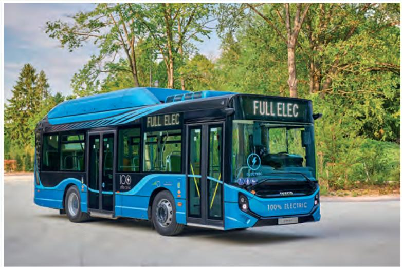
mediante toma Combo 2 CSS o carga de oportunidad mediante pantógrafo descendente o ascendente. Una combinación de 5 a 7 packs para una capacidad total de 346, 416 o 485 kWh optimizará el rendimiento del autobús.
