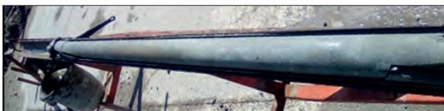
Figura 18. Testigo en zona de solape de columnas a tresbolillo.
