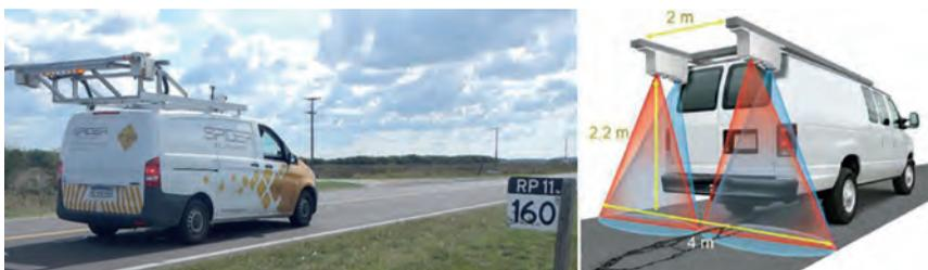
Figura 1. Equipo multifunción SPIDER-LCMS ITYAC.
