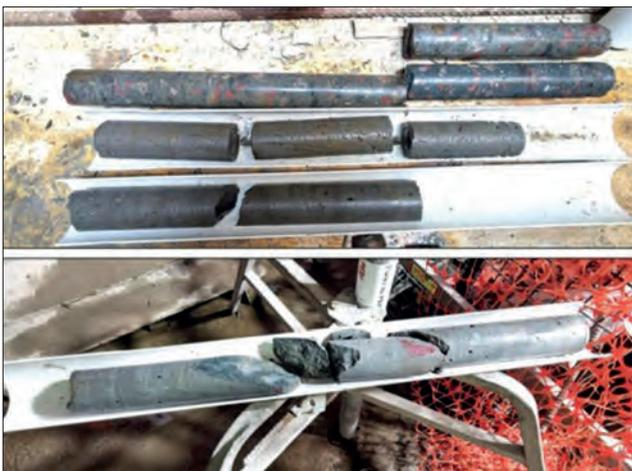
Figura 23. Extracción de testigos horizontales en el perímetro de la abertura.
