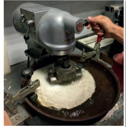
**Figura 3.** Ensayo WTAT sobre marcas viales.
