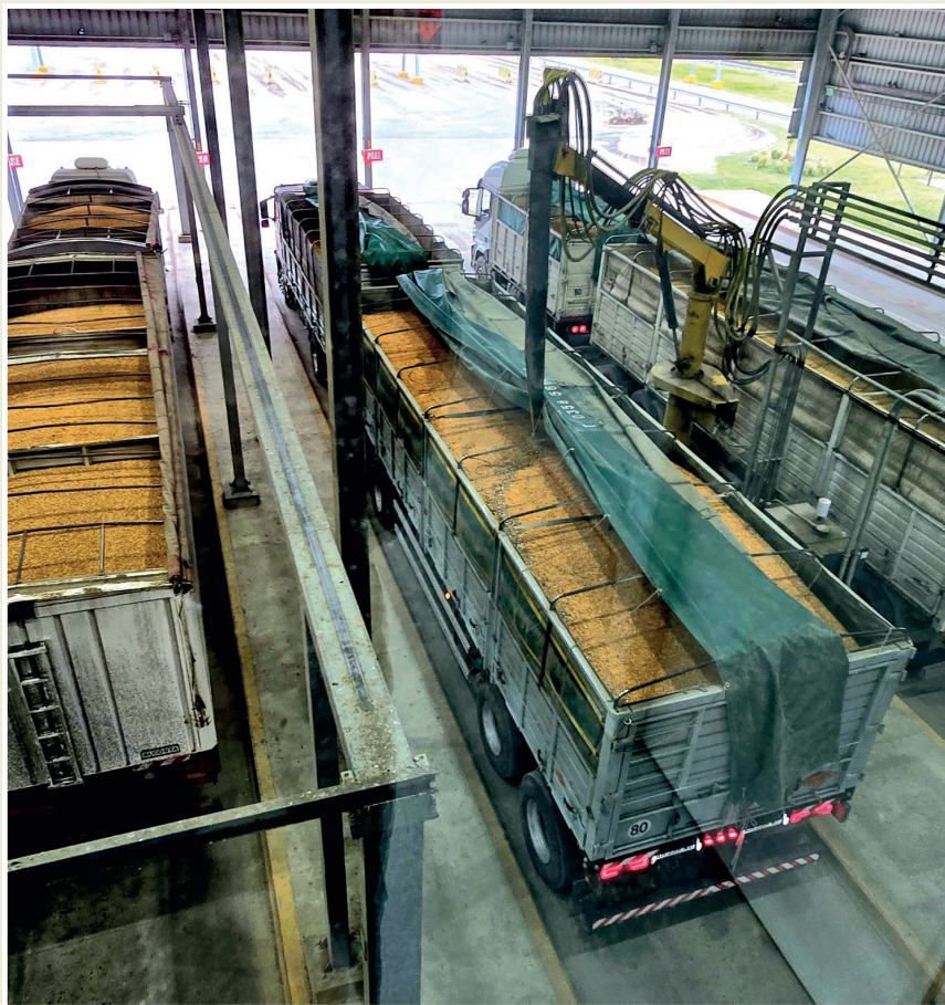
Toma de muestra de granos de cada carga totalmente robot izado, para su clasificación.
