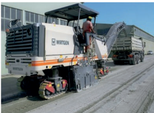
Fresadora de medio carril. Fuente: www.wirtgen.de (2).
