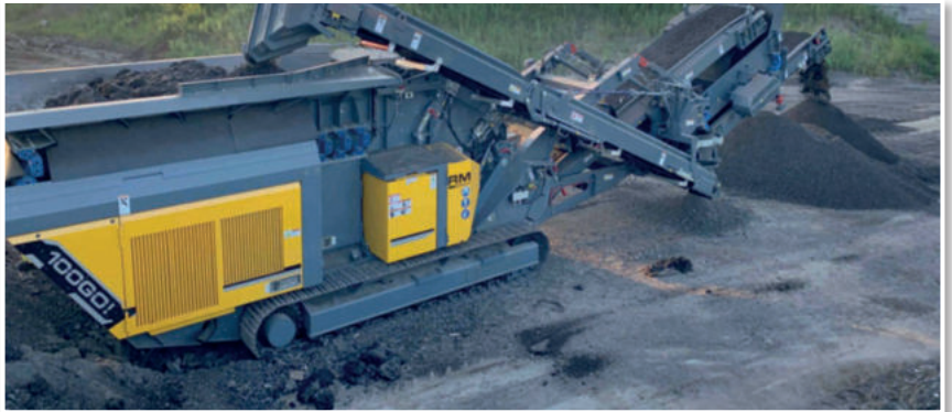
Planta móvil con trituradora de impacto procesando RAP. Fuente: www.rubblemaster.com .
