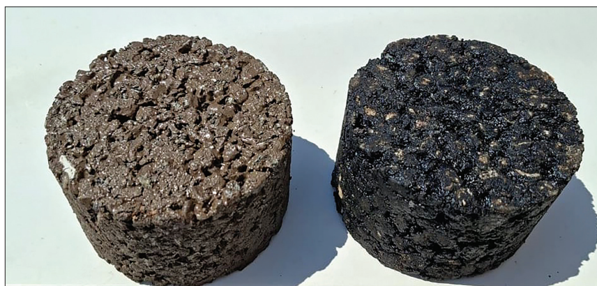
Figura 2. Probeta Marshall de mezcla asfáltica convencional (izquierda) y modificada con \text{TiO}_2 (derecha)
