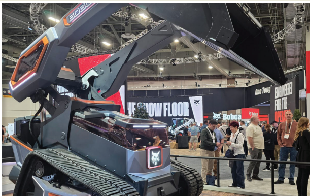
Bobcat RogueX3, una cargadora compacta de orugas de la línea de innovación eléctrica de Bobcat. Al no tener escape visible y presentar un diseño futurista con iluminación LED, se identifica como una máquina de cero emisiones, ideal para trabajos en interiores o zonas con restricciones ambientales.
