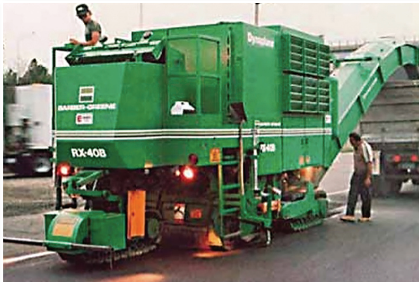
Figura 2. Equipo de perfilado en frío (fresadora), en los años 1970.
