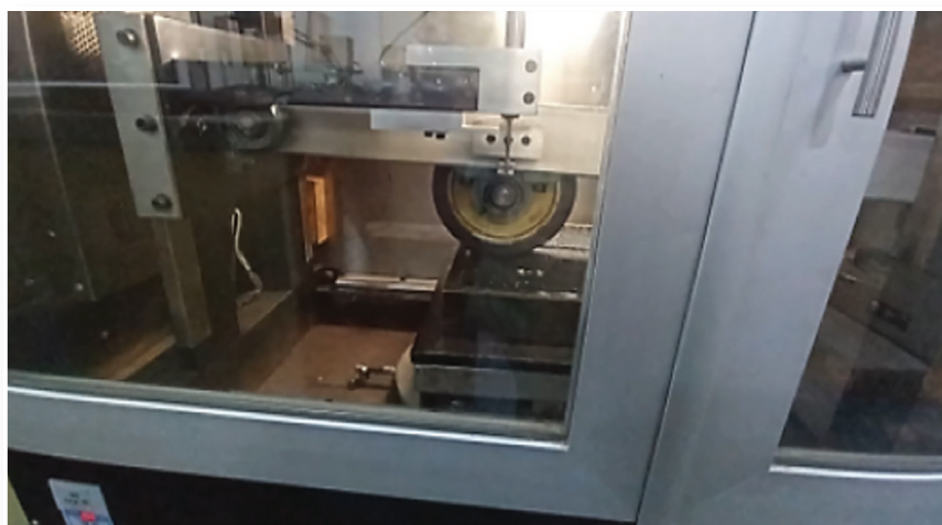
Figura 8. Probeta durante el ensayo de WTT en el LEMaC UTN FRLP -CIC PBA
